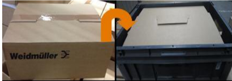
Abbildung 10: Darstellung der modularen Nutzung von Einsätzen aus Kartonage (links) in Euronormbehältern (rechts)
